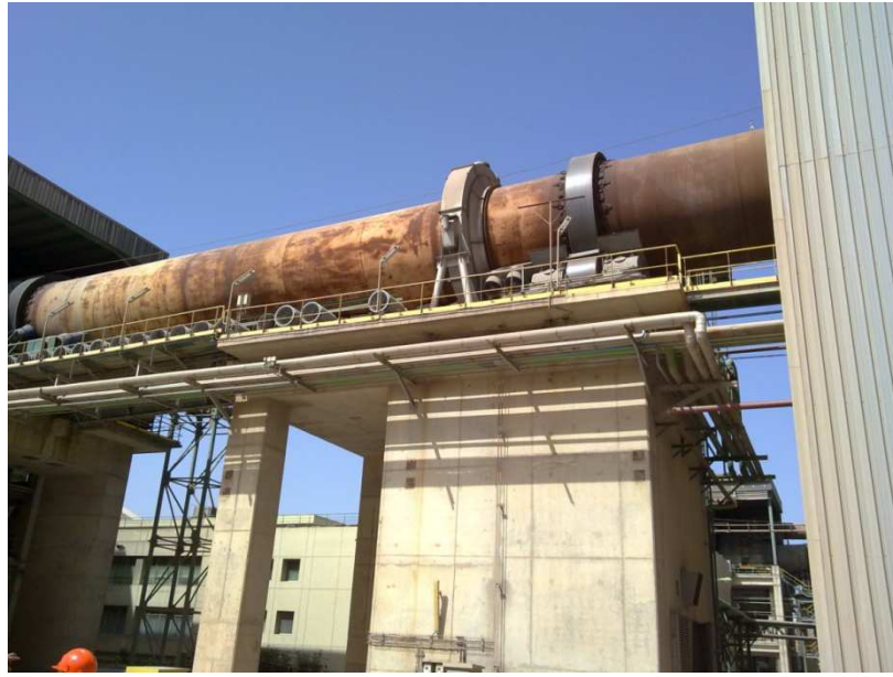
Figure 27 : Four rotatif pour la cuisson de Clinker
