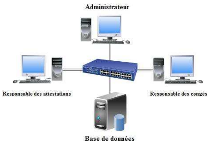
Fig4 - Architecture réseau du projet
