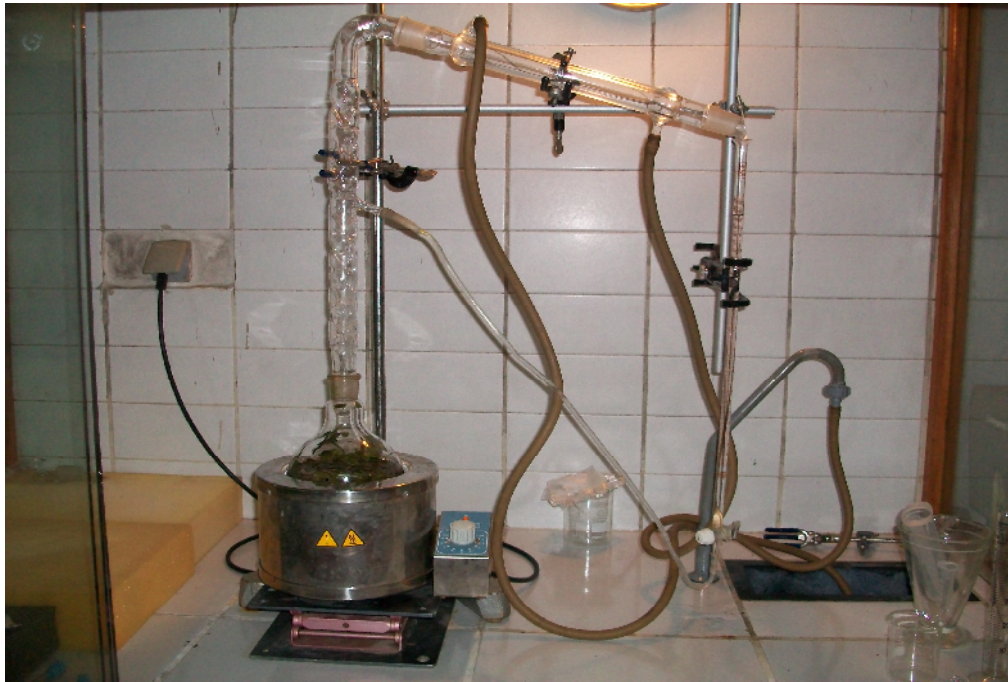
Fig.1: Système d'hydrodistillation (FSDM-FES)
