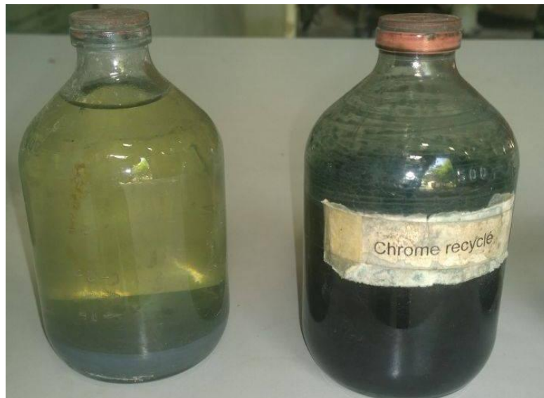
Figure 7 : échantillon du précipité du chrome recyclé
