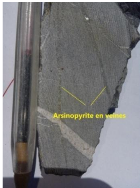
Figure 52 :.Des filonnets d'arsénopyrite dans les grès
