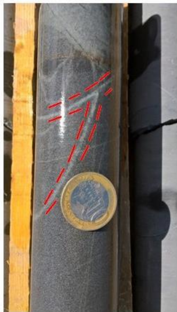
Figure 55: les filons de chlorite encaissés dans les grès
