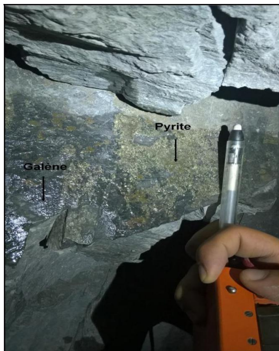
Figure 26 : Photo de pyrite et galène dans les pélites –gréseux
