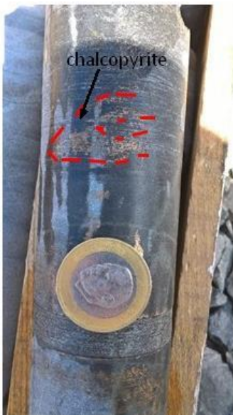
Figure 54 : minéralisation de la chalcopyrite dans les grés pelite
