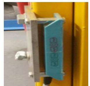
Figure 19: Le capteur de fin de course du gerbeur
