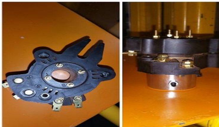
Figure 26: L'alimentation par le collecteur rotatif
