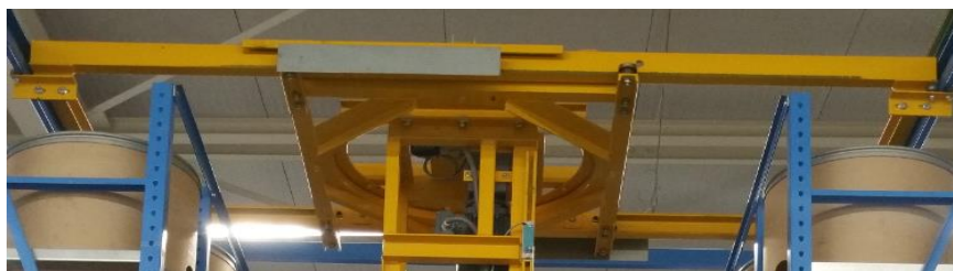
Figure 17: le système de translation et rotation du gerbeur
