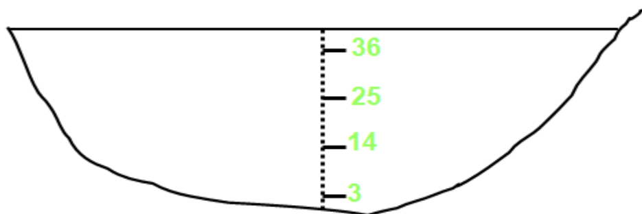
Figure 4 : les points de mesure choisis dans une verticale
