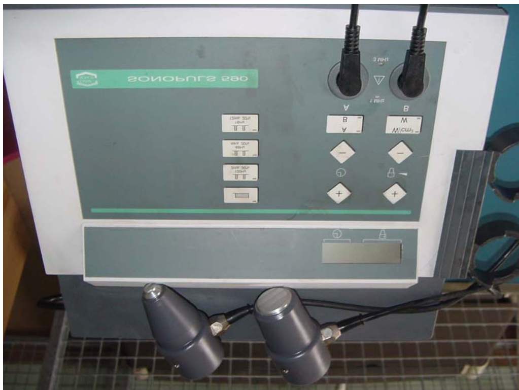
Photo 28 : Appareil à ultrasons Sonopuls 590 ® (Enraf Nonius)
