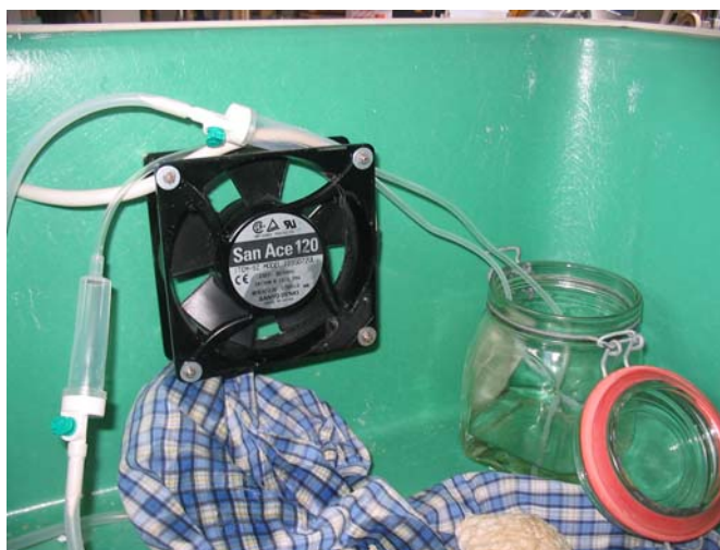
Photo 8 : Pompe à membrane et réserve de durcisseur dans la chambre hermétique de durcissement
