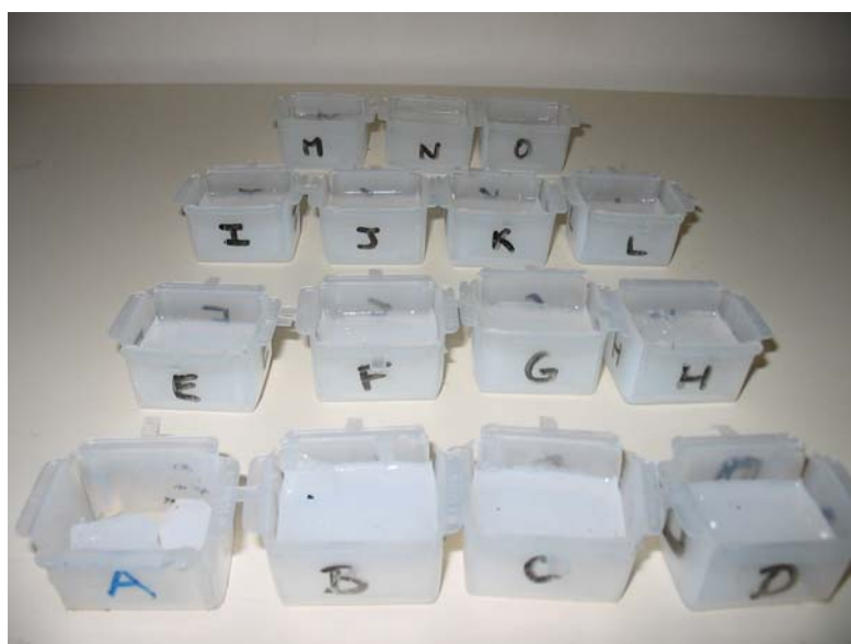
Photo 18 : Pavés de silicone dilué de 0 à 70 % v/v
