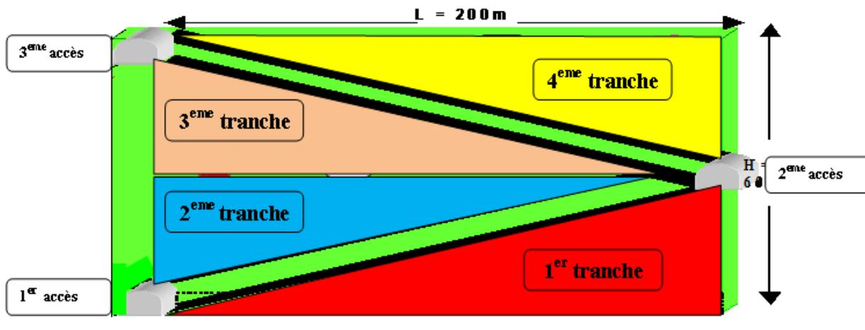
Figure 8 : Méthode d'exploitation dans lamine d'el hammam (TMR)
