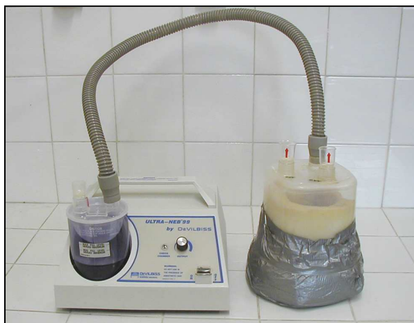
Figure 9 : Matériel d'inoculation (nébulisateur DeVillbiss UltraNeb 99 et masque d'inoculation).
