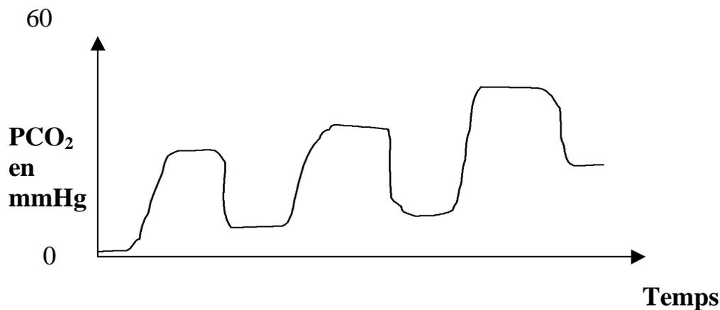
**Figure 13 :** chaux sodée usagée ou valve expiratoire défectueuse (49).
