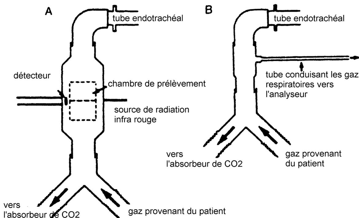
**Figure 4 :** capnomètre de type « mainstream » (A) et de type « sidestream » (B).
