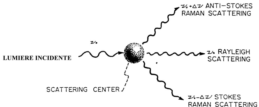
**Figure 3 :** les différentes dispersions de RAMAN après absorption d'une lumière incidente.
