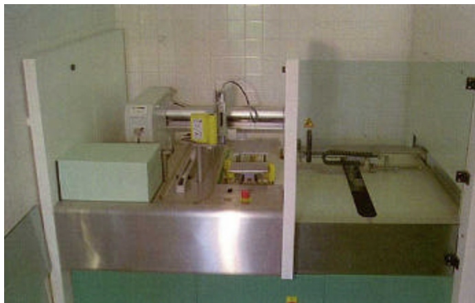
photo 10 : automate analysant les paramètres sanguins
