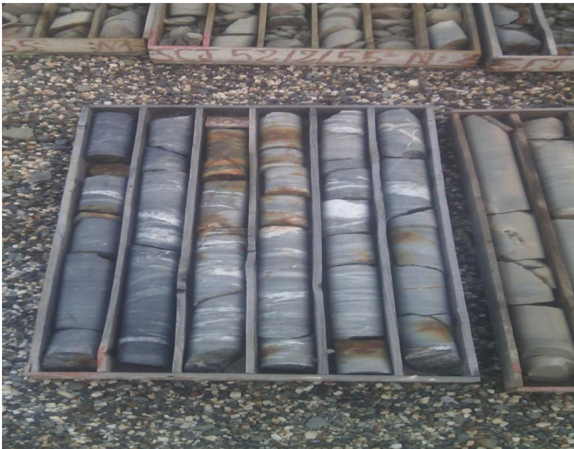
Figure 14 : caisses à carotté de sondage SCJ 52/2/-55°
