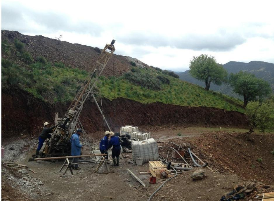
Figure 34 : sondeuse LY 38 au cours du sondage réalisé
