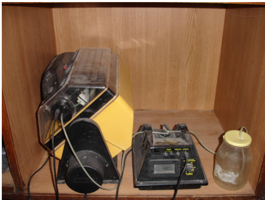
Figure 38 : Couveuse à retournement automatique (à gauche) avec contrôleur d'humidité (au milieu et son réservoir d'eau (à droite). Le système de chauffage est intégré dans le couvercle ainsi que le thermostat (avec l'aimable autorisation de M. Philippe Moulin)
