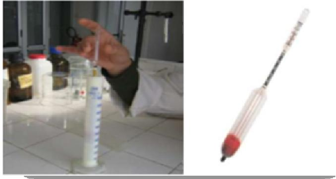
Figure 10 : Mesure de la densité du lait par lactodensimètre
