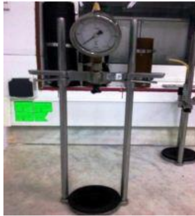
Photo 5 : Zahm munie d'un manomètre
