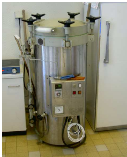
Figure 96: Autoclave utilisé pour la stérilisation des solutions biologiques
