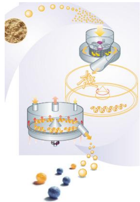
Figure 13 : l'extrusion-sphéronisation (Glatt GmbH, 2006)
