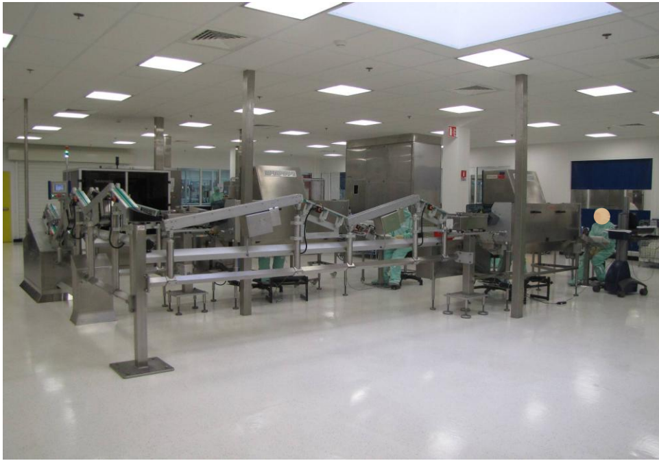
Figure 10 : nouvelle ligne de mirage : convoyeurs et mireuses semi-automatiques
