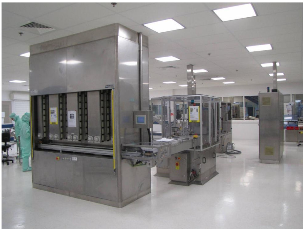
Figure 8 : nouvelle ligne de mirage : étagère dynamique et dénesteur
