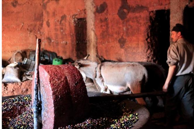
Figure 6 : broyeur à meule avec traction animale
