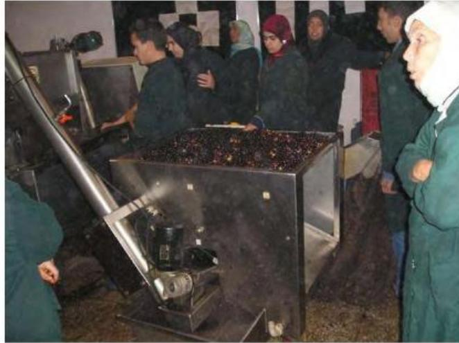
*Figure 4 : Manière de broyage des olives par un broyeur à marteau*
