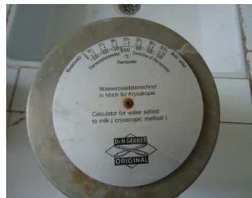
*Cryoscope de Gerbert standard et son disque calculeur pour le mouillage*
