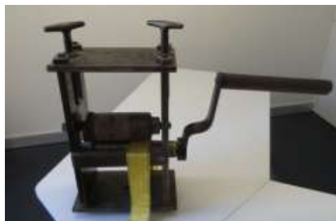
Figure 4 et Figure 5: Machine à gaufrer les couleurs des compagnons tisseurs ferrandiniers – 1872 (non cotée)
