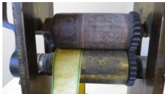
Figure 4 et Figure 5: Machine à gaufrer les couleurs des compagnons tisseurs ferrandiniers – 1872 (non cotée)
