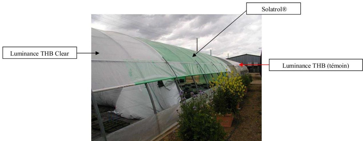
▲ Figure 7 : Bâches testées sur la station du CDHR Centre Val de Loire
