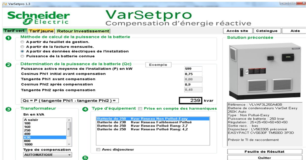
Figure 40: résultats des caractéristiques du compensateur du PTF
