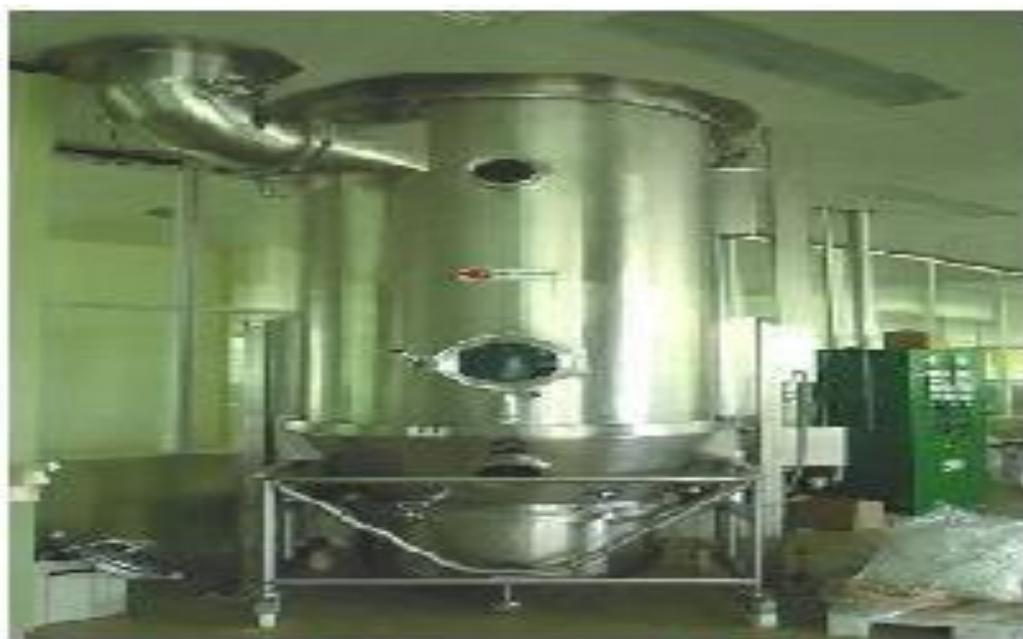
Figure 9 : Sécheur de la levure
