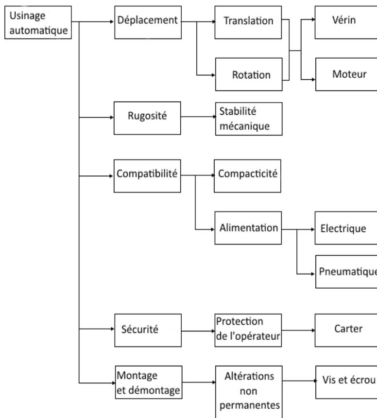
Figure 10 : Diagramme de FAST
