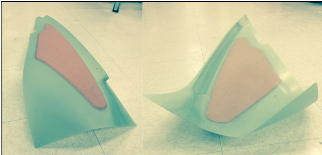
Figure 3.30 Pièce typique avec un noyau en mousse
