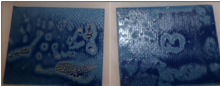
Figure 3.15 Exemple d'œil de poisson sur un composite contaminé
