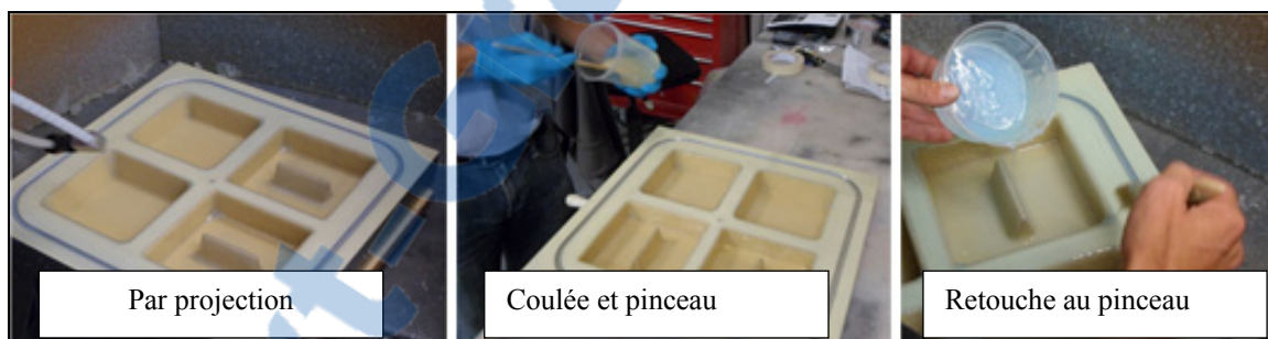
Figure 3.5 Moule de torture, fabrication des membranes
