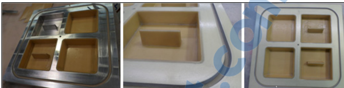
Figure 3.4 Moule de torture, application de la cire calibrée
