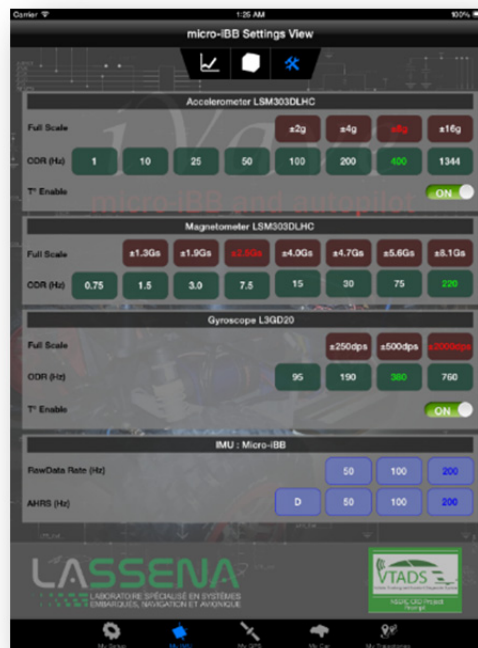
Réglage de la sensibilité des capteurs inertiels
