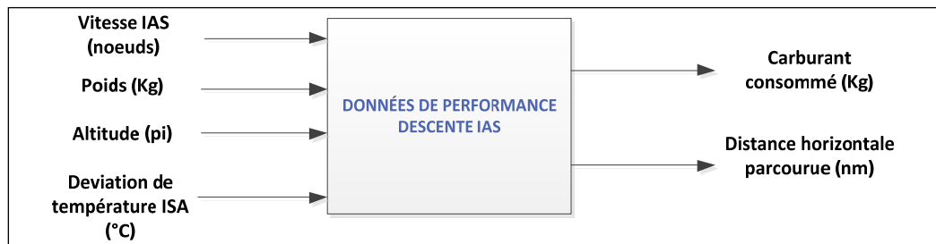
Figure 2.11: Entrées et sorties des données de performances pour la phase de descente en IAS
