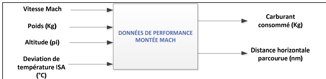
Figure 2.8: Données d'entrées et de sorties de la phase de montée en Mach
