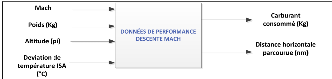
Figure 2.10: Données des entrées et des sorties de la phase de descente en Mach
