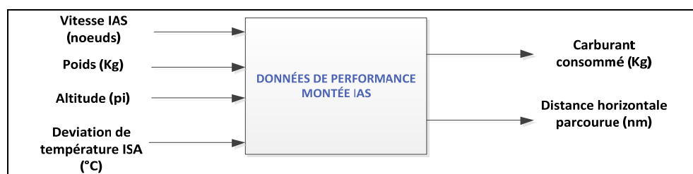
Figure 2.5: Données d'entrées et de sortie de la montée en IAS
