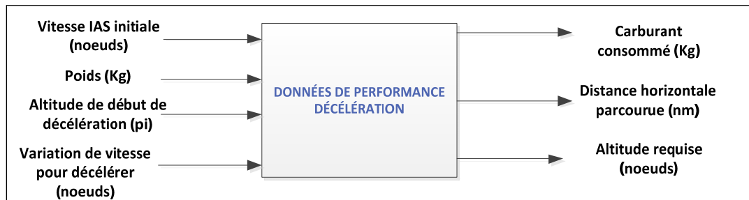
Figure 2.12: Entrées et sorties des données de performance de la phase de décélération
