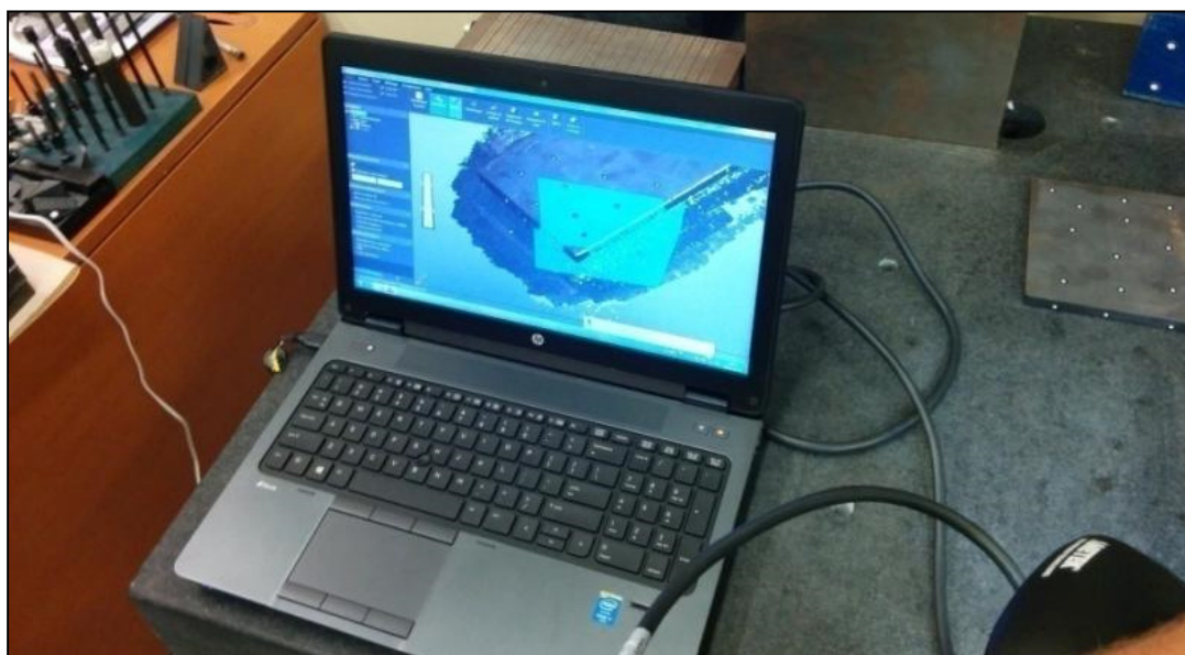
Figure 3.12 Acquisition des données du Go! Scan 20 par le logiciel VXelements
