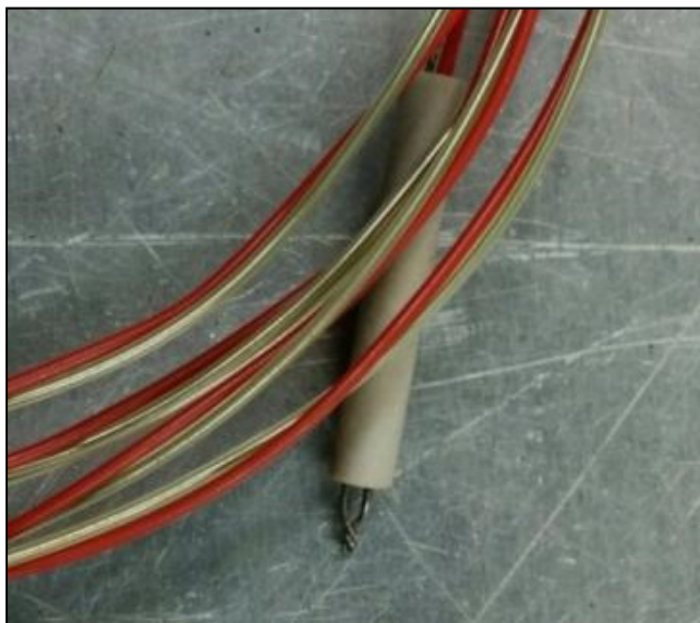
Figure 3.16 Photo d'un thermocouple assemblé (torsadé)
