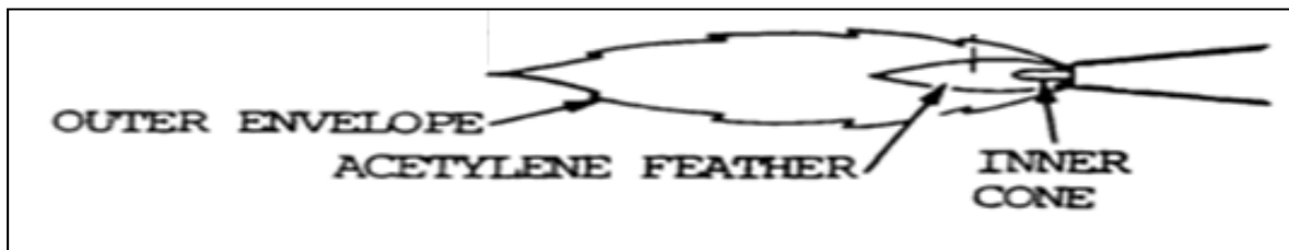
Figure 3.20 Schéma des zones d'une flamme de chalumeau oxygène acétylène Tirée de http://www.roadkillcustoms.com/hot-rods-rat-rods/welding/Ch11.asp#fig11_1
