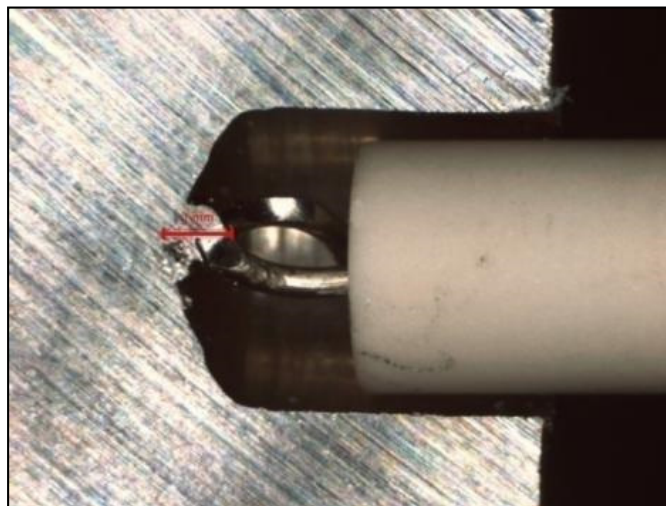
Figure 3.18 Vue de coupe d'un thermocouple soudé au fond d'un trou
