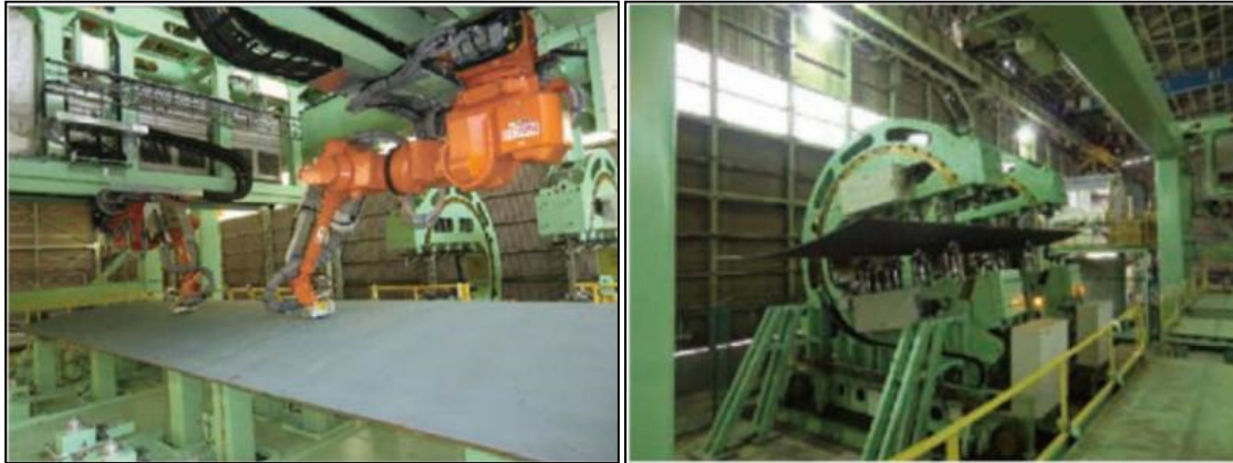
Figure 2.2 Machine de mise en forme par ligne de chauffe Tirée de H. Kim (2012)
