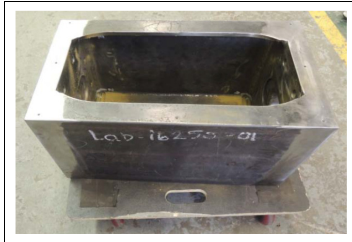
Figure 6.12 État post-soudage du prototype prêt pour les contrôles non destructifs
