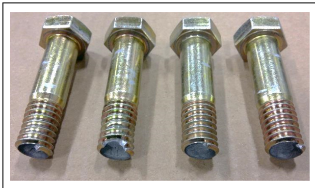
Figure 7.7 Boulons inférieurs sectionnés lors des essais mécaniques
