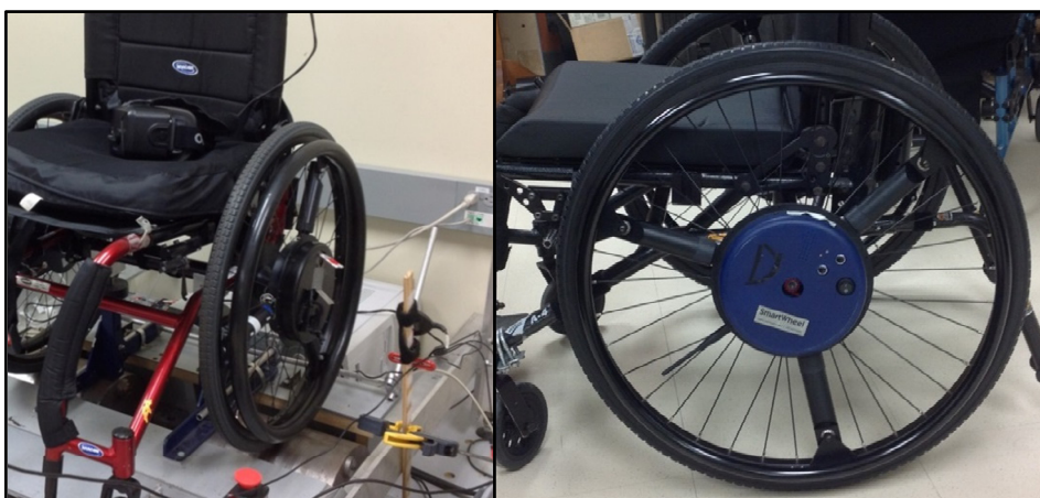
Figure 1.5 Photo de gauche: SmartWheel, modèle à signaux infra-rouges. Photo de droite: SmartWheel à signaux wifi
