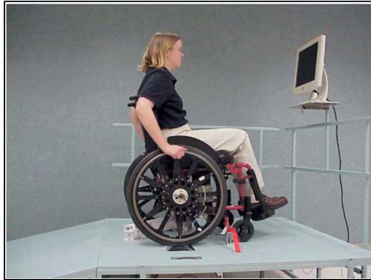
Figure 1.6 Exemple de système comprenant un ergomètre à rouleaux. Figure tirée de Kotajarvi et al. (2006)
