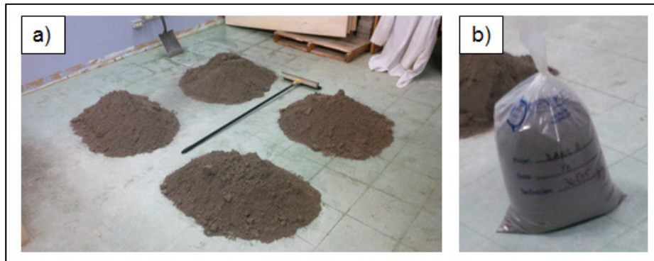
Figure 2.7 a) Processus d'homogénéisation du till par quartage; b) Sac d'échantillonnage utilisé pour entreposer les spécimens quartés
