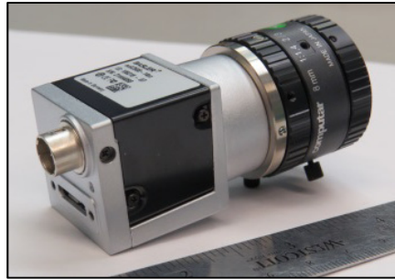
Figure 2.3 Caméra numérique ACA2500 de Basler avec lentille Computar M0814-MP
