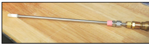
Figure 2.10 Assemblage d'un tube rigide contenant une pierre poreuse
