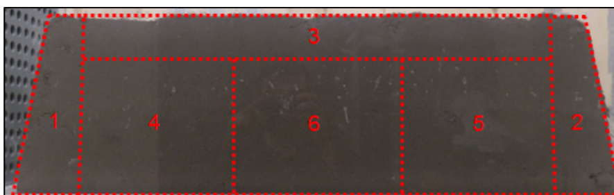
Figure 2.14 Sections du noyau prélevées après chaque essai
