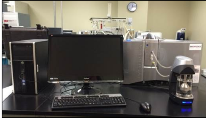
Figure 2.4 Granulomètre laser Mastersizer 3000 de Malvern Instruments
