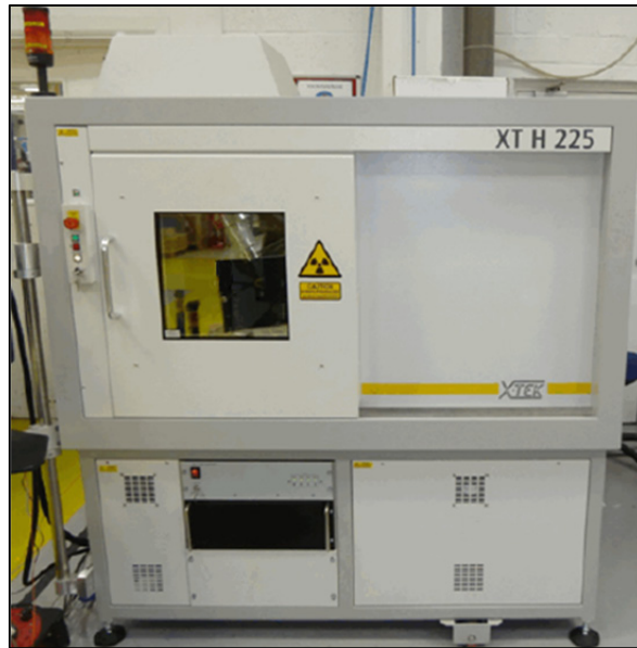
Figure 2.6 Tomodensimètre XTH225 Adaptée de Nikon Metrology (2012)
