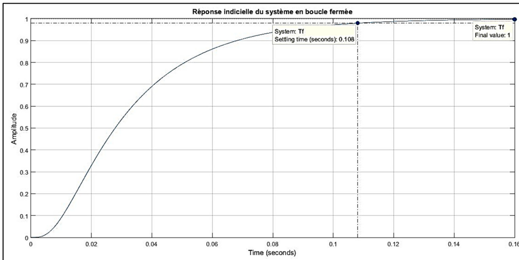
Figure 5-33 Réponse indicielle en boucle fermée pour \varepsilon=0.2 , M=1.2 , \gamma=10
