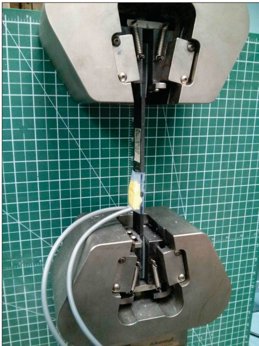
Figure 4.1 Montage de l'essai de tension
