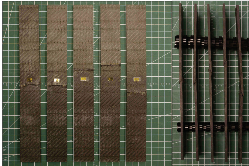
Figure 4.5 Exemple de spécimens de compression post-mortem
