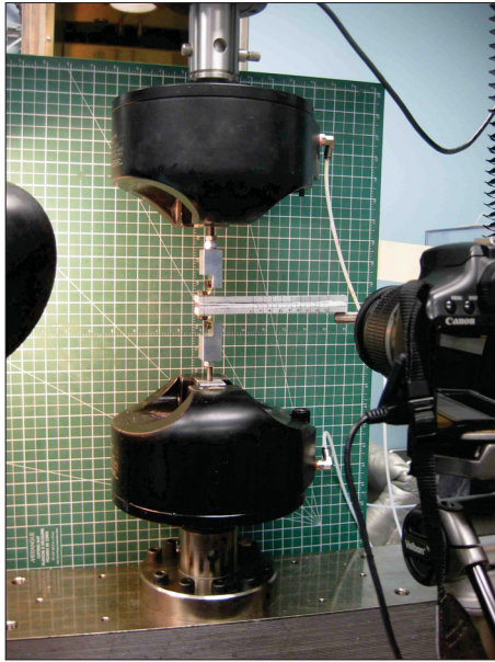
Figure 5.11 Montage de l'essai de propagation d'une fissure interlaminaire
