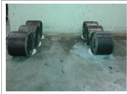
Figure 2.14 Éprouvettes Marshall avant démoulage
