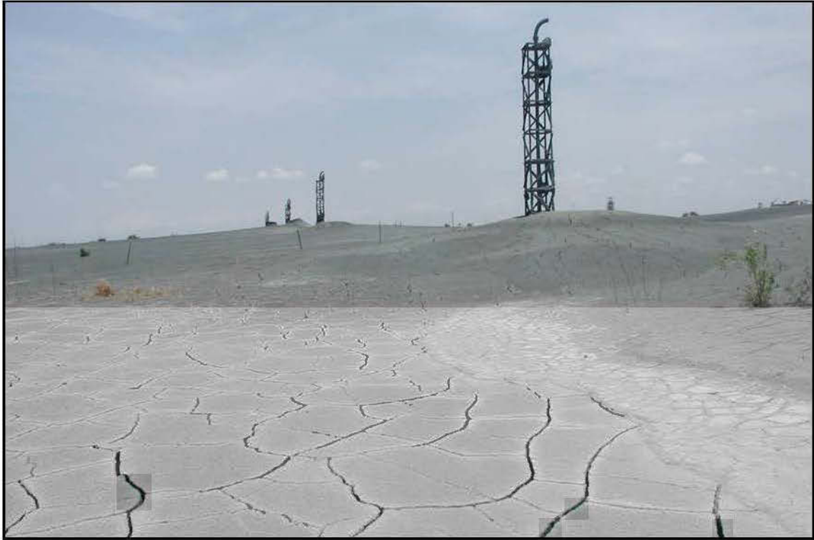
Figure II.8. Dépôt de résidus miniers en pâte de surface, à la mine de Bulyanhulu, Tanzanie (Photo Vincent Martin).
