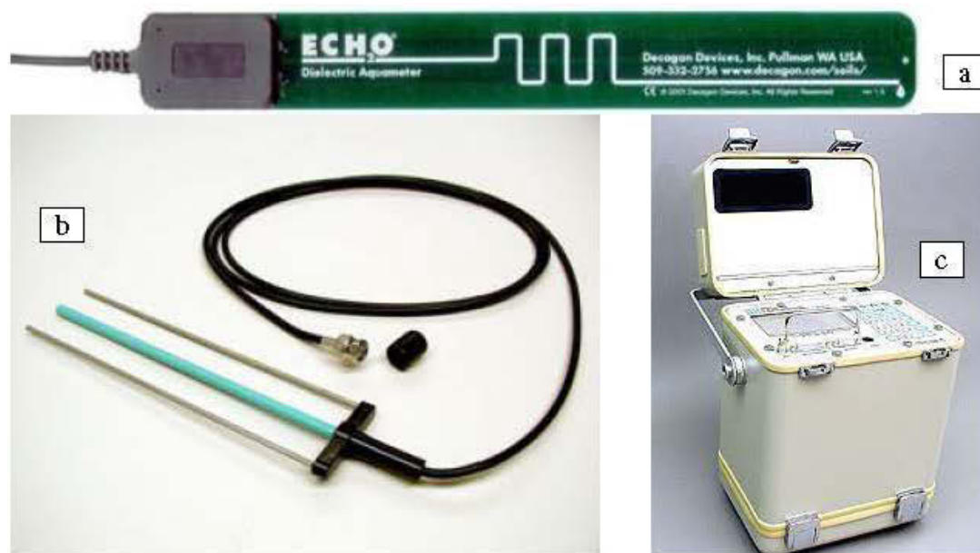
Figure A.1. Photographies (a) des sondes ECH 2 O, (b) des RTD « coated » et (c) du boîtier Trase d'acquisition de données pour la RTD.
