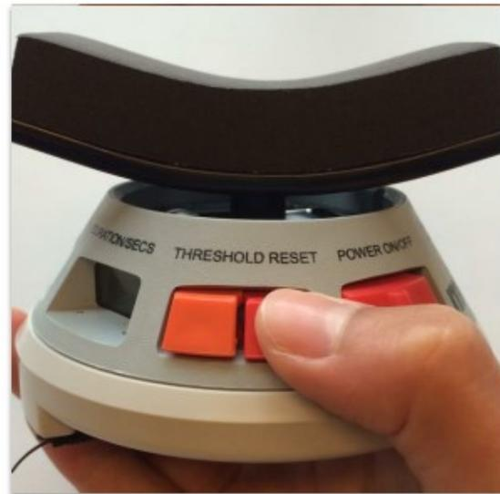
3) Enclencher le mode « High Threshold » en pressant sur le bouton « THRESHOLD » 1 ou 2 fois jusqu'à ce que « H » s'affiche.
