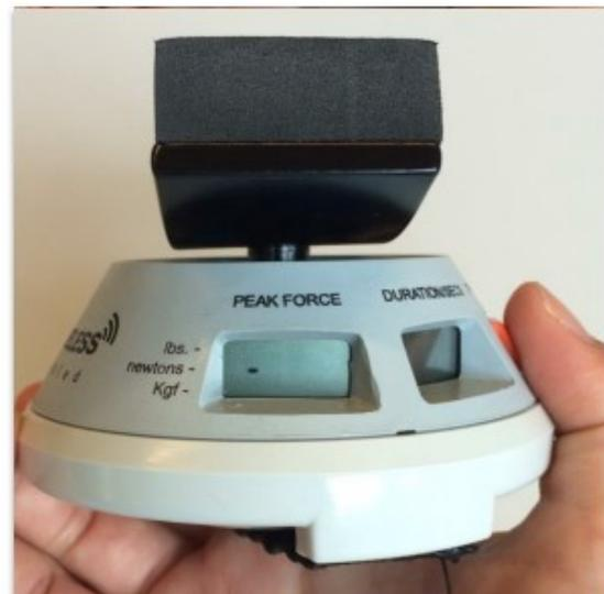
5) Appuyer sur le bouton « THRESHOLD » pour sélectionner l'unité de mesure newton.
