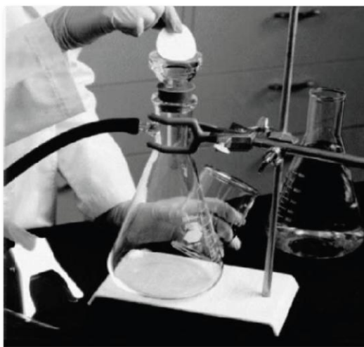
Figure 16 : Disque pour l'extraction sur phase solide et son dispositif 180 .
