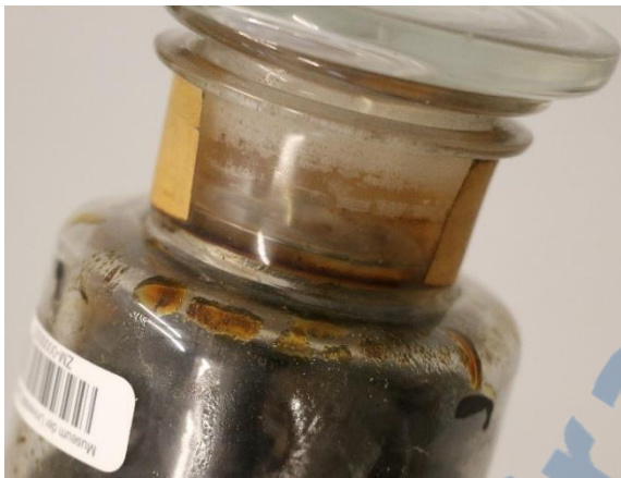
Fig. 36 : Dépôts sur la jonction bouchon et encolure du contenant ©M.Dangeon, He-Arc CR, 2016
