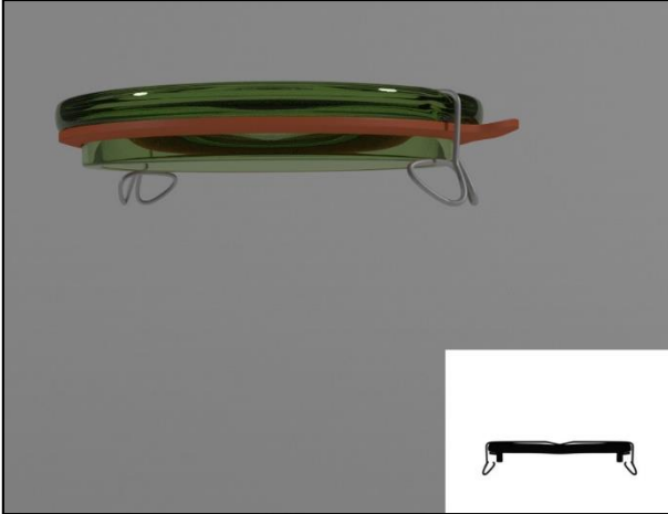
Forme 11 : couvercle verre avec joint caoutchouc et système de plaquage métal
