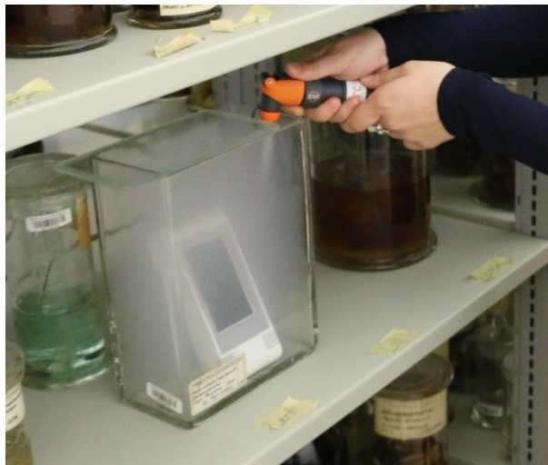
Fig. 60 : injection de CO 2 dans l'enceinte avec le capteur ©M.Dangeon, He-Arc CR, 2016
