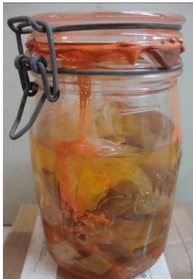
Fig. 7 : Joint de caoutchouc dégradé ayant coulé dans le bocal et sur le spécimen ©J. Cuisin, 2015
