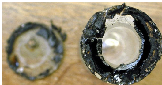
Fig. 6 : Scellement au bitume ©S. Moore, 2007
