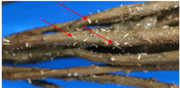
Fig. 30: cristallisations en forme d'aiguille sur le spécimen ©M.Dangeon, He-Arc CR, 2016
