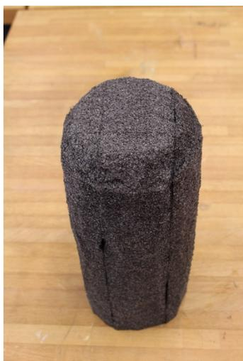
Figure 75. Mousse PE à la base du support de la tête.
