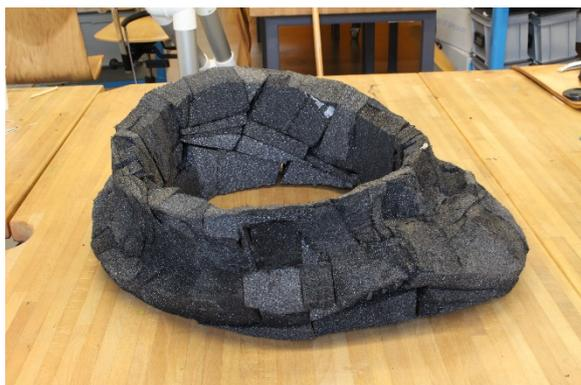
Figure 85. « Anneau » après thermosoudage des blocs.
