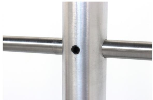
Figure 70. Assemblage entre la tige horizontale et le tube vertical de la structure centrale cruciforme.
