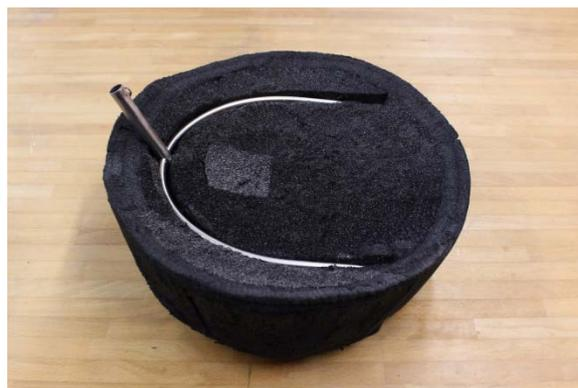
Figure 80. Insertion de l'armature métallique dans la mousse PE du support des épaules.
