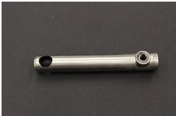
Figure 73. Tube horizontal faisant partie de l'armature métallique de chaque épaule après usinage.
