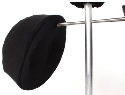
Figure 82. Support d'une épaule inséré sur la structure métallique centrale.
