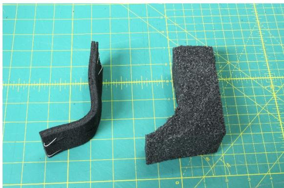
Figure 83. Fin rectangle en mousse PEHD renforcé avec du fil de fer pour réaliser le support de la jupe et le bloc réalisé à partir du profil enregistré.
