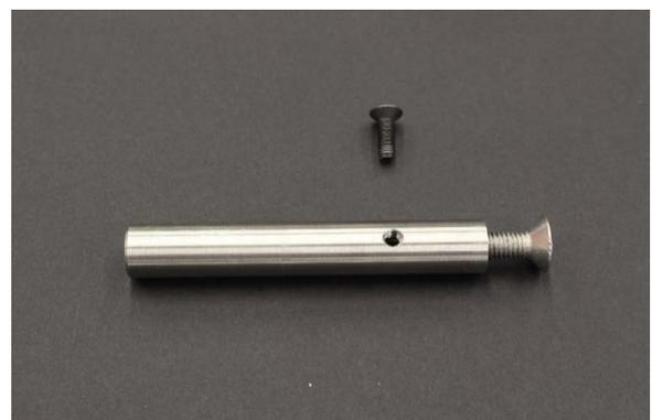
Figure 66. Tenant de la base après usinage.
