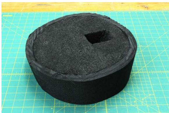
Figure 79. Contre-forme en mousse PE pour le support des épaules.
