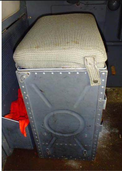
**1. Retirer le coussin d'assise du siège :** déboutonner les quatre languettes qui maintiennent le coussin à sa base métallique.
