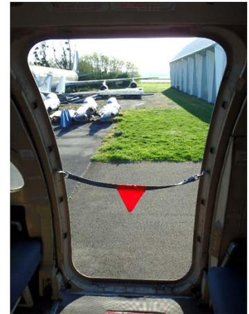
Figure 29 Porte de secours situé à l'avant de l'appareil pouvant être ouverte
