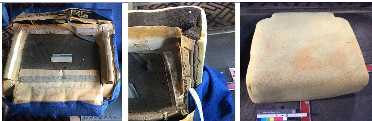
Figure 32 2<sup>ème</sup> étape : retirer la housse de l'assise
