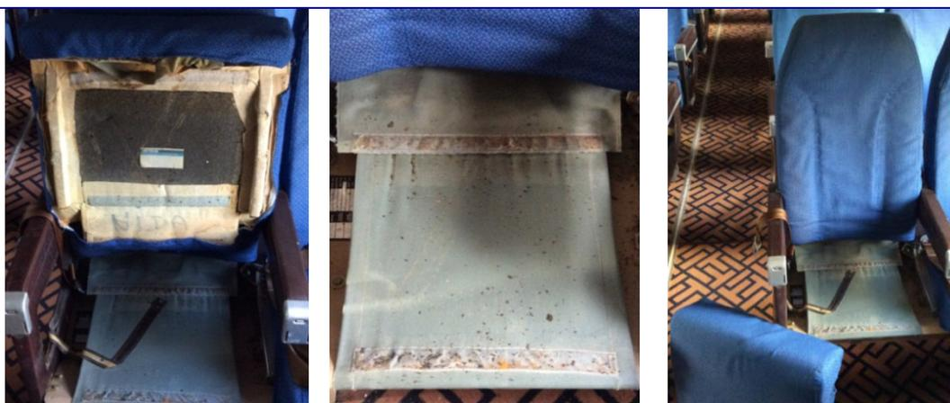
Figure 31 1<sup>ère</sup> étape du démontage : retirer l'assise du siège
