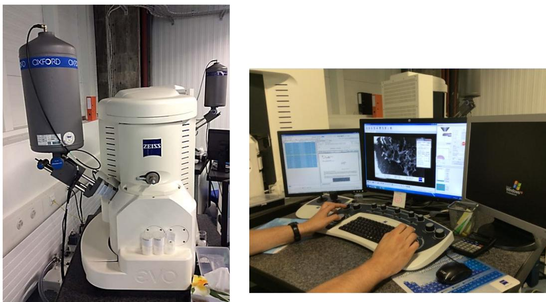
Figure 54 Dispositif MEB-EDS
