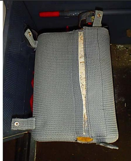
**2. Retirer la housse du rembourrage de l'assise :** détacher le velcro de l'ouverture présente sur le dessous du coussin, puis retirer la mousse contenue à l'intérieur.
