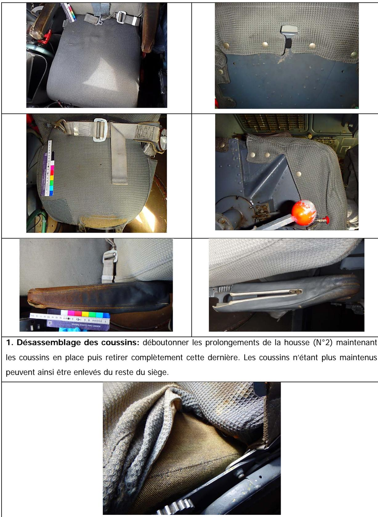
**2. Retrait du rembourrage des coussins :** Les coussins ne présentant aucune ouverture permettant d'accéder à la mousse, il est nécessaire de défaire une des coutures<sup>94</sup>. Pour cela plusieurs recommandations peuvent être suivies :
