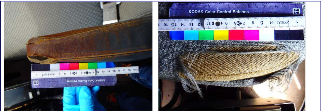
Figure 19 Le revêtement en cuir des accoudoirs et la housse de protection sont dégradés
