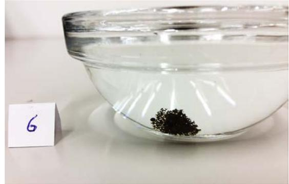
Figure 34 La mousse de type B, de par son état dégradé et sa charge potentielle inorganique coule rapidement <sup>42</sup>
