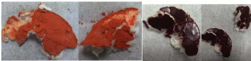
Figure 6.1 Photos du dépôt du polymère P2 (à gauche) et P3 (à droite) dopés, sur la pâte Kraft
