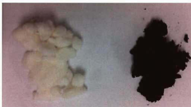
Figure 6.17 Pâte propargylée avant (à gauche) et après (à droite) greffage de la polyaniline azidée dopée
