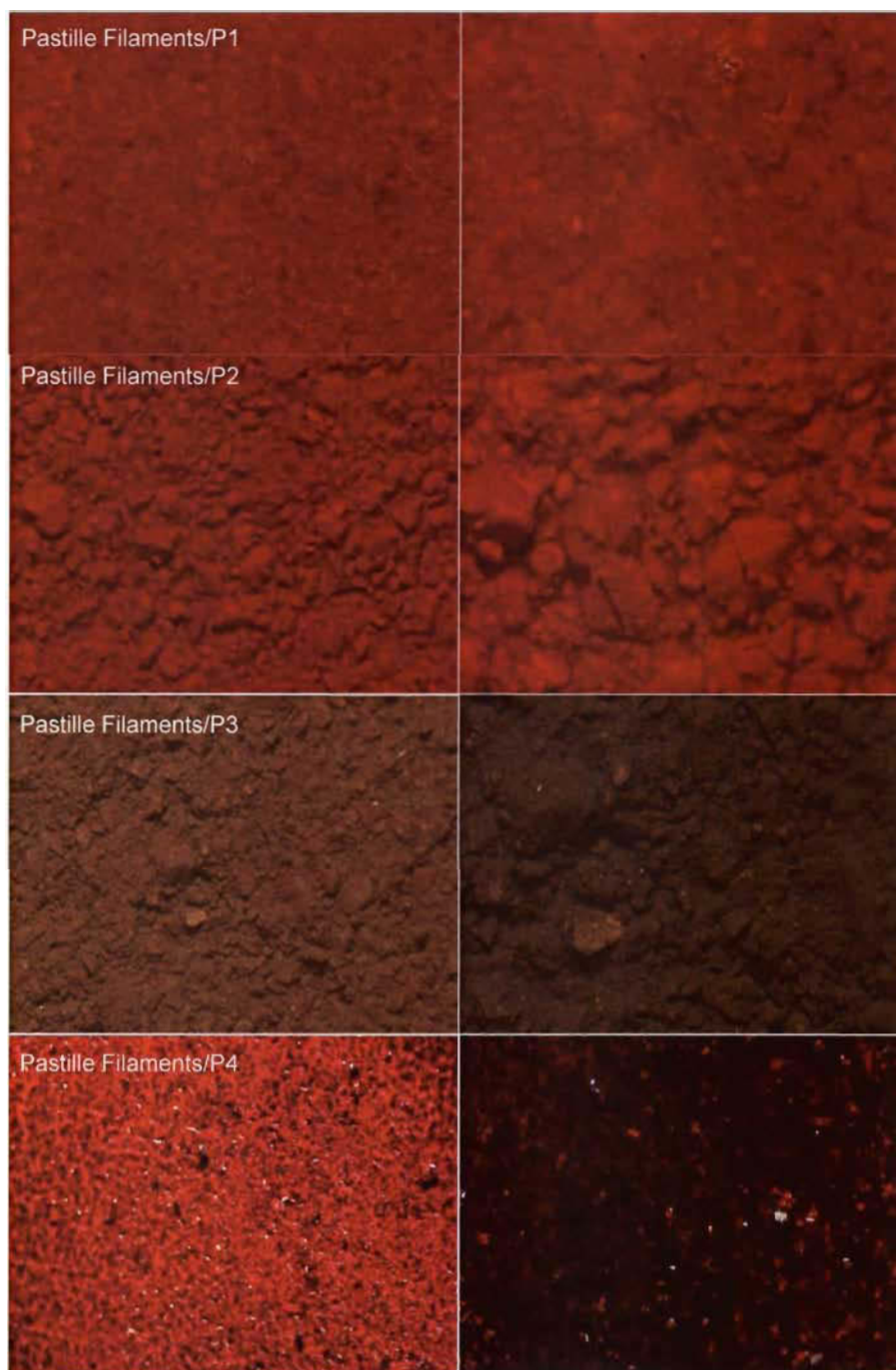
Figure 6.4 Images au stéréoscope des pastilles Filaments/Polymères avec un grossissement de 20X (à gauche) et 50X (à droite).
