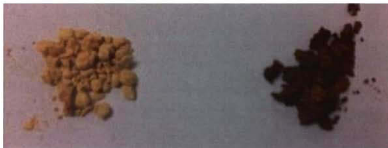
Figure 6.25 Oligomère P1 azidé avant dopage (gauche) et après dopage (droite)
