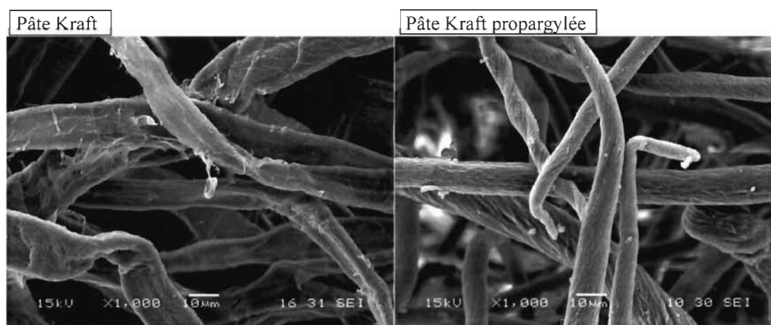
Figure 6.14 Clichés MEB des fibres cellulosiques de pâte Kraft : avant (à gauche) et après modification (à droite)
