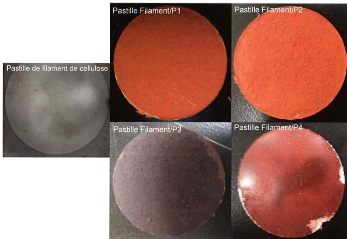
Figure 6.3 Photos de la pastille de filaments de cellulose à gauche et des pastilles après le dépôt des polymères P1 à P4 sur les filaments.
