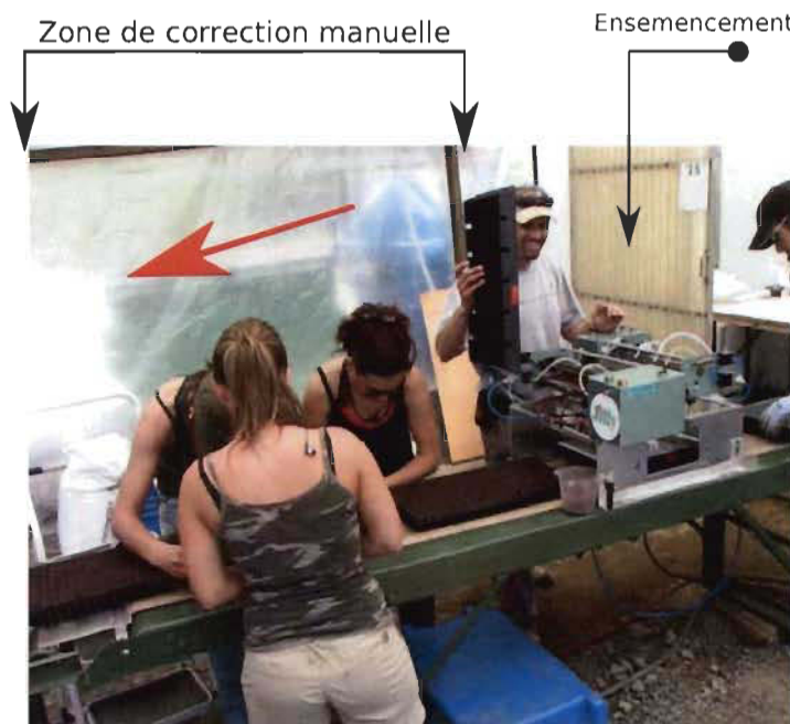
FIGURE 1.4 - Processus d'assurance qualité manuelle : les préposés à l'assurance qualité détectent les erreurs par la vue. À noter que la flèche indique le sens de défilement du convoyeur.
