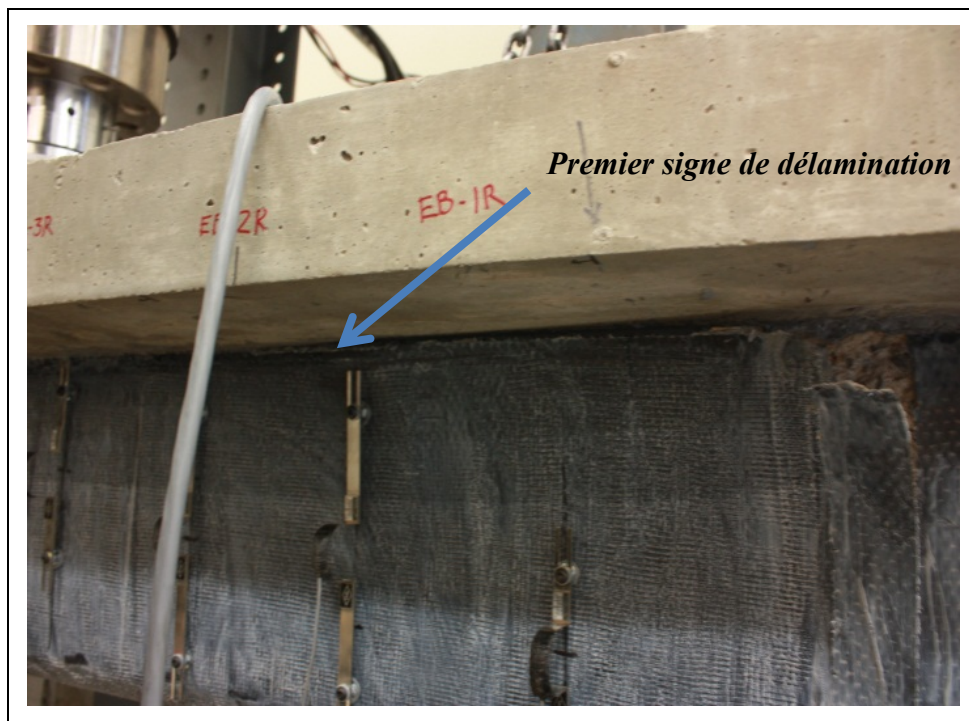
Figure 5.7 Dé laminage du renfort du spécimen S1-EB
