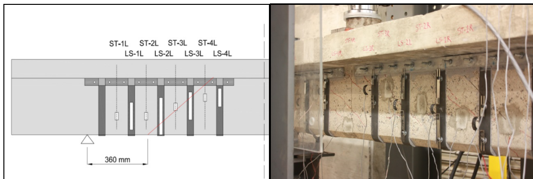
Figure 5.35 Observation du spécimen S1-LS-BA (fissure en rouge)
