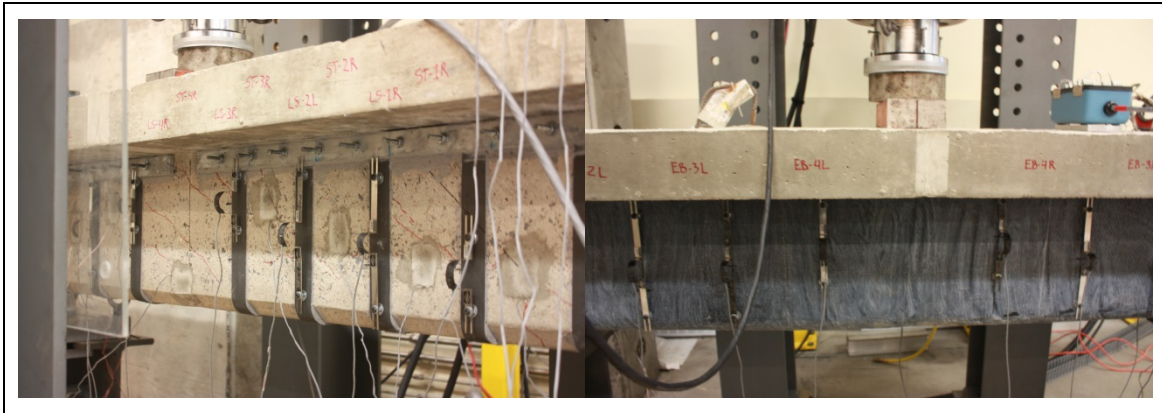
Figure 3.12 Jauges sur renfort externe
