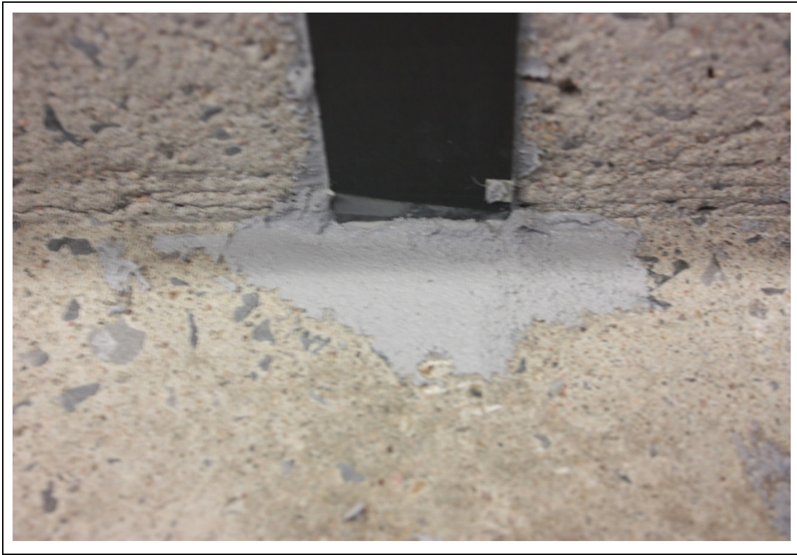
Figure 3.6 Préparation du spécimen S1-LS-PA, ancrage partiel
