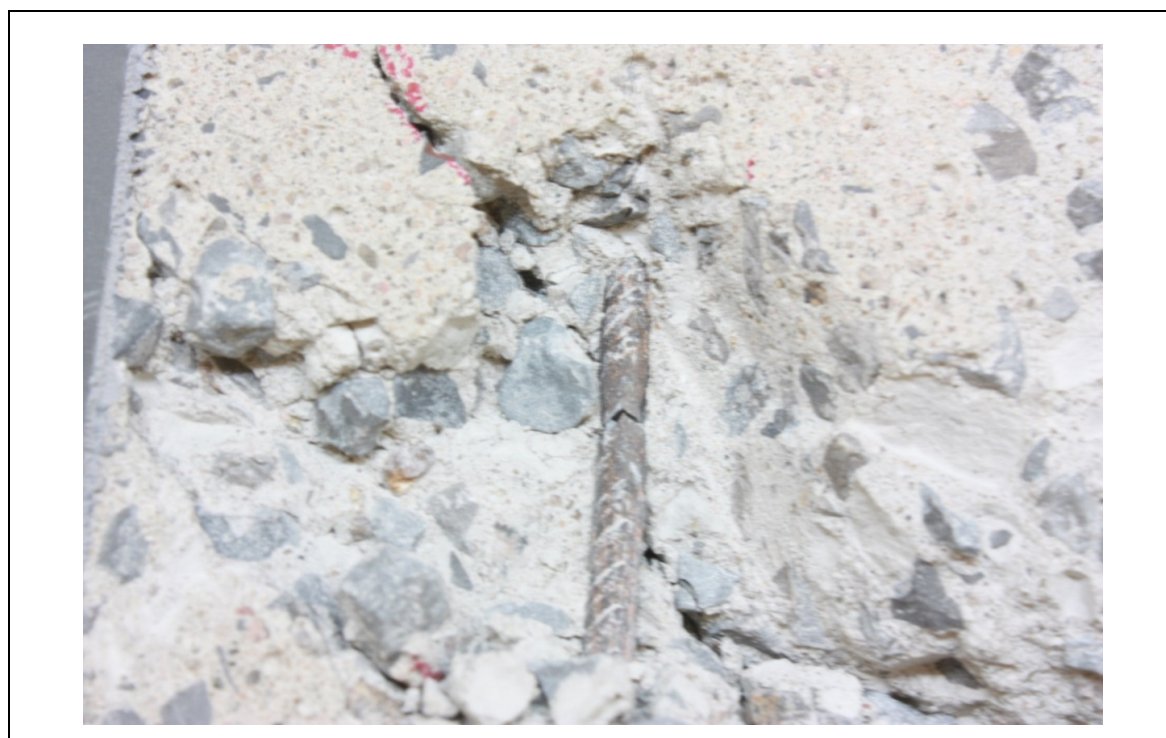
Figure 5.42 Rupture de l'étrier ST-3L pour spécimen S1-LS-BA
