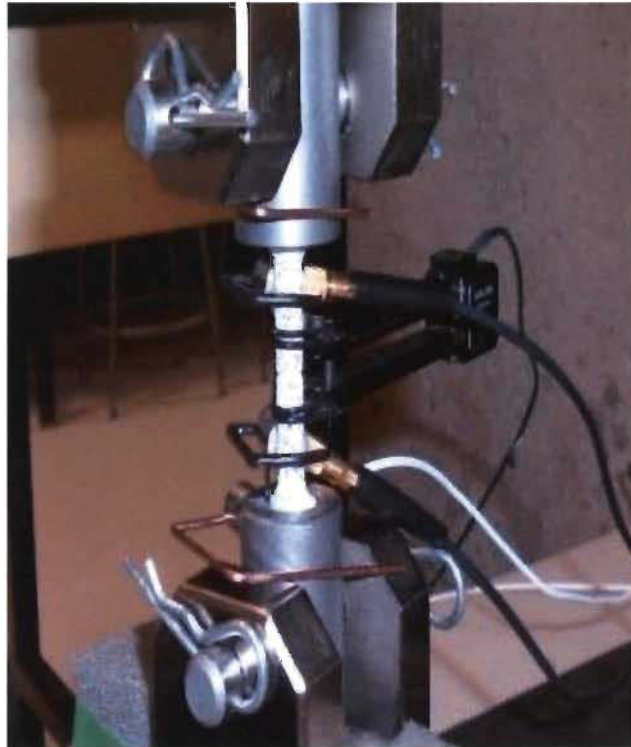
Figure 2.7: Installation des capteurs sur l'éprouvette
