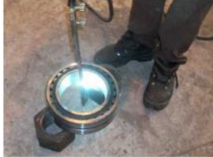
Figure 18: chauffage de roulement
