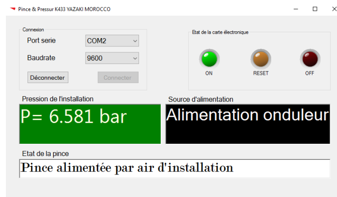
Figure 43 : L'interface graphique dans le cas de coupure d'alimentation et P > 5 bar
