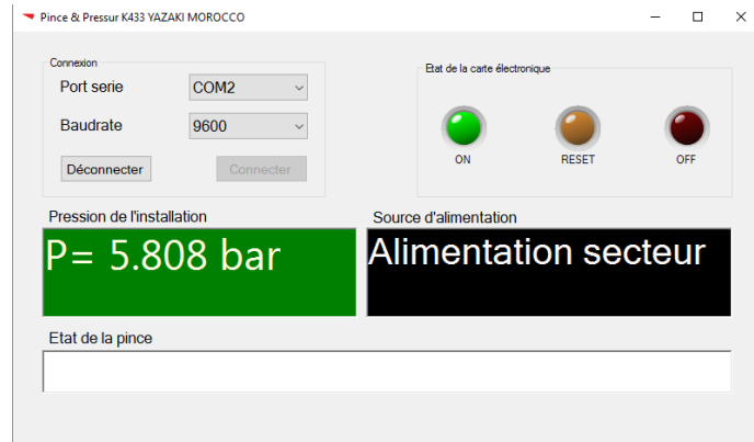
Figure 39 : L'interface graphique en fonctionnement normal
